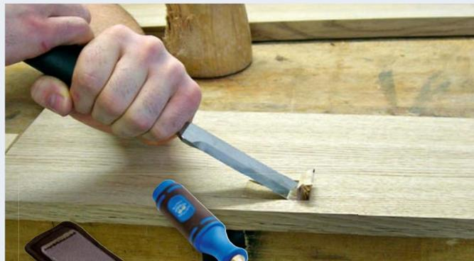
leistet durch den im Salzbad auf 60 Rockwell gehärteten Stahl. Der Clou ist aber die Seitenschneide des 2-Cut. Hat man sie zur Verfügung, fällt erst auf, wie oft man sie braucht: Kartons aufschneiden, Klebeband durchtrennen, eine neue Leimflasche öffnen, per Schlag eine feine Linie im Holz anzeichnen und vieles mehr: Der Griff zum Holster des 2-Cut am Gürtel geschieht häufiger, als man es erwartet hätte. Bild-
